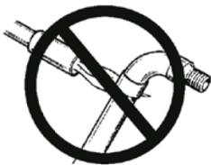
Les systèmes de tuyaux PEX ne doivent pas être intentionnellement soumis à la congélation. Ne pas utiliser de chalumeau ou une chaleur excessive pour dégeler les tuyaux PEX, des dommages ou la défaillance des tuyaux pourraient en découler. La chaleur doit être appliquée directement à la section de tuyau qui est congelée. La température sur le tuyau ne doit pas excéder 85°C (180°F).
