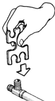
5. Lors de la vérification des raccords à l'aide de la jauge GO NO-GO, descendre la jauge PERPENDICULAIREMENT vers la bague. Ne JAMAIS insérer la jauge en la glissant. Ne pas essayer de mesurer le sertissage dans les zones de renflement de la bague sertie.
