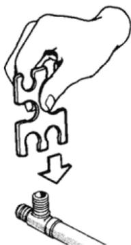
2. Faire glisser le côté GO d'une jauge du calibre approprié sur la bague à au moins QUATRE endroits. NE PAS jauger le sertissage à la zone de chevauchement des mâchoires de l'outil.
